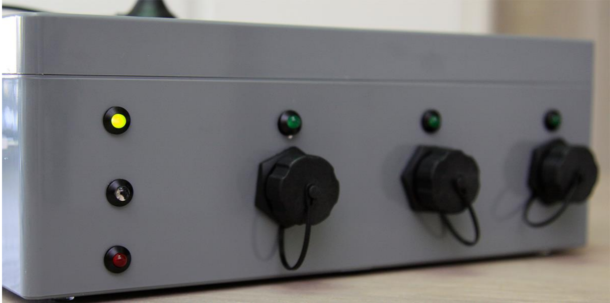
Figuur 3: Toestel in normale werking: groene LED linksboven brandt
