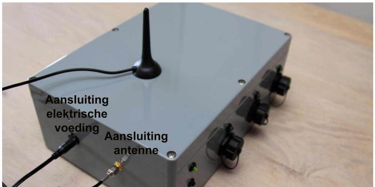
Figuur 2: Aansluiting van de antenne en elektrische voeding
